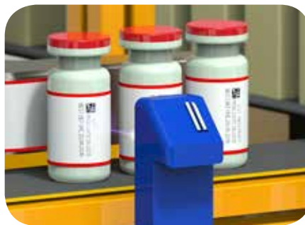
Bei der Lasercodierung werden wichtige variable Produktinformationen direkt oder auf laseraktivierbare Etiketten aufgebracht.
